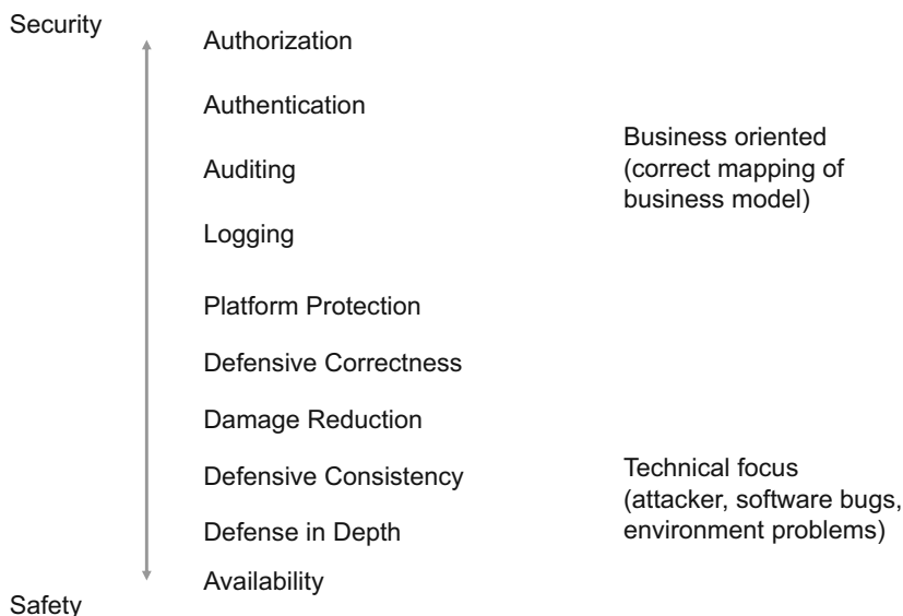
Abb. 1.1 Sichere Systeme als Kombination der Aspekte Security und Safety
