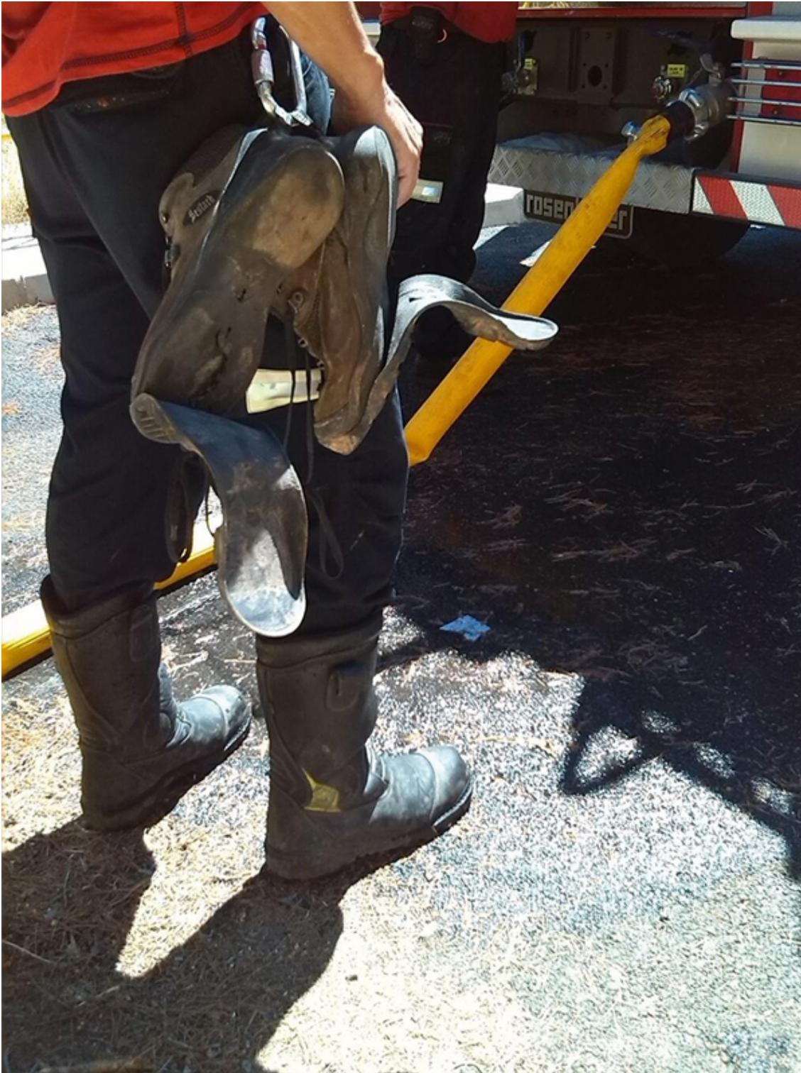
**Bild 2:** Beispiel eines nicht angepassten Schuhs, die Sohle hat sich während der Löscharbeiten auf heißem Boden abgelöst. Ein Weiterarbeiten in diesem Zustand kann sehr gefährlich werden! (Foto: @fire)
