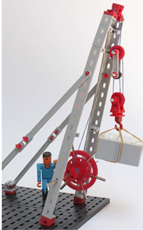
Abb. 1–4 fischertechnik-Modell eines Trispastos
