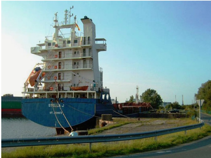
Abb. 3.6 Deckshaus eines Containerschiffs von achtern gesehen
