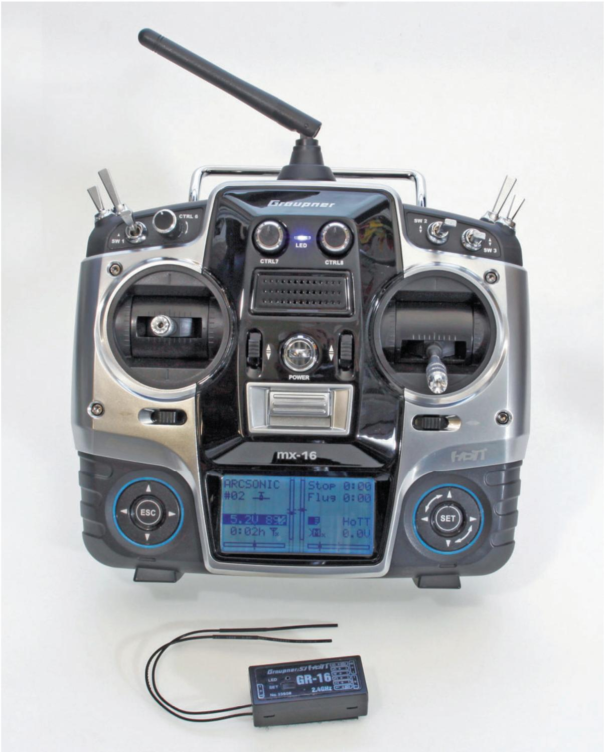
Abb. 1.2 – Ein untrennbares Gespann: Sender und Empfänger.
