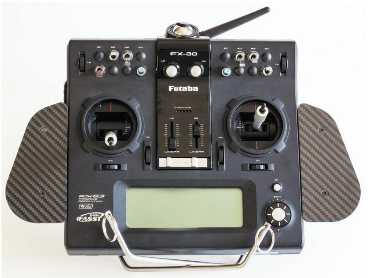
Abb. 1.1 – Ein ehemaliger 35-MHz-Sender ist mit einem modernen 2,4-GHz-Modul ausgestattet: die FX-30 von robbe/Futaba.
