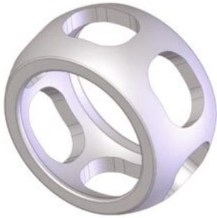
BILD 1.5 Beispiel eines 3D-Modells (Kugelkäfig)
