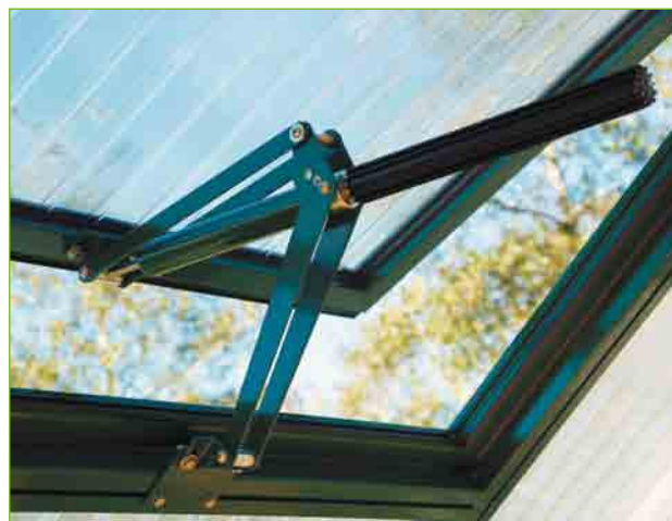
Abb. 3.11 – Fensteröffner mit Wärmefühler ohne Strombedarf, Ausführung für schwere Fenster. Quelle [2]
