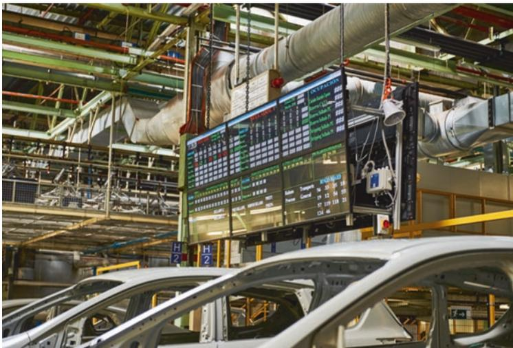
**Abb. 1.6** Durch die Informationstafel können alle Mitarbeiter im Ford-Werk Valencia den aktuellen Stand der Produktion erkennen. (Foto: Ford)
