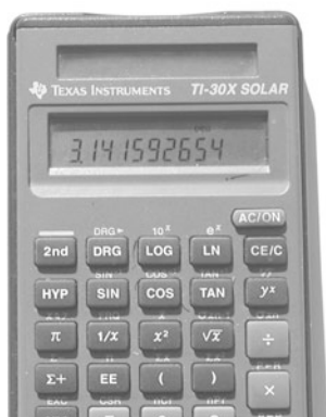
Abb. 1.1 Einsatz von Solarzellen bei einem Kleinverbraucher im Milli wattbereich ( links ), Solarkraftwerk mit mehreren Megawatt Leistung ( rechts )
