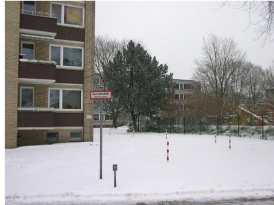
**Bild 3 und Bild 4:** Feuerwehzufahrten müssen im Sommer wie im Winter deutlich zu erkennen und befahrbar sein. Dazu muss eine eindeutige Kennzeichnung des Fahrweges erfolgen. Gut zu erkennen, ist auch die Beschilderung nach DIN 4066 (Bilder: J. O. Unger)
