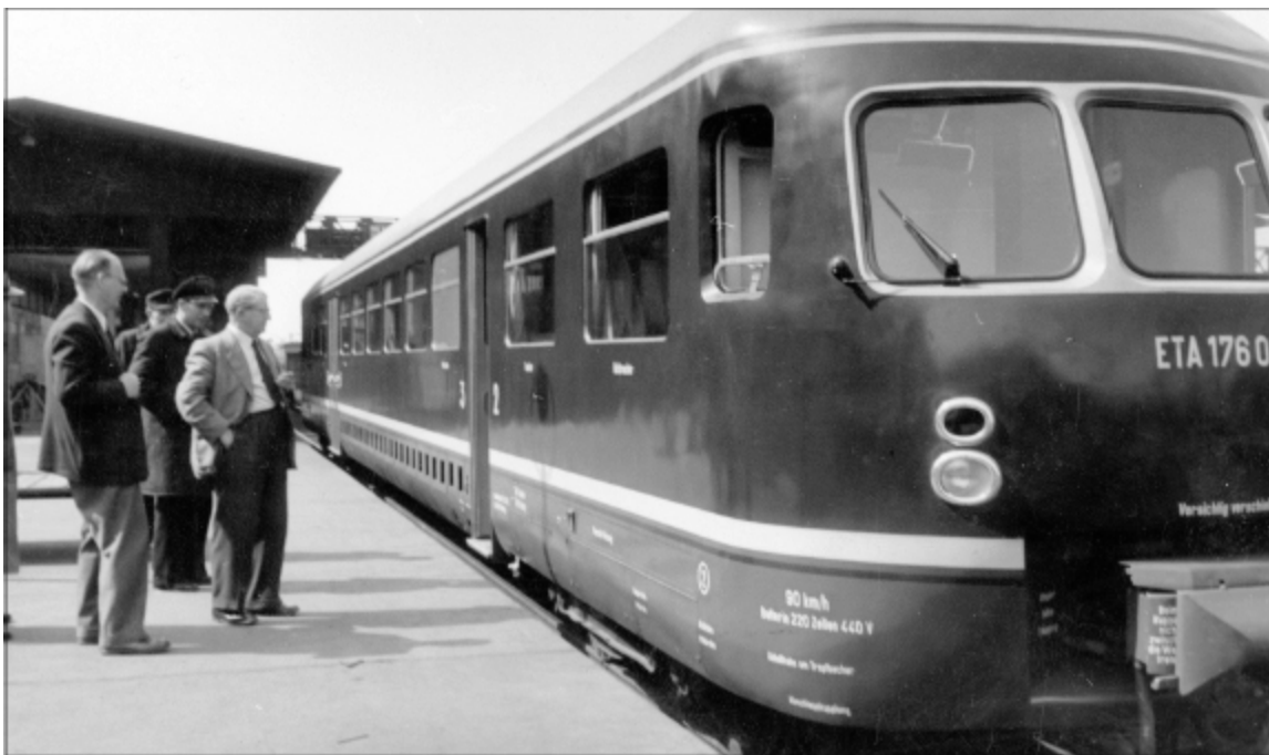
Beziehungsreiche Erinnerung: LUDWIG TÄGERT (links im Bild) an einem fortschrittlichen Triebwagen seines Maschinenamtes Hameln, dem von Akkus und Elektromotoren getriebenen „kleinen Roland“ ETA 176 006
