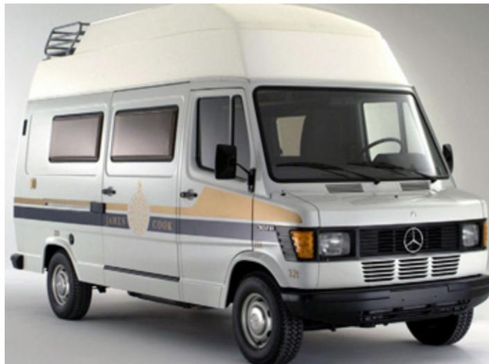
Die Fenster, seitlichen Schiebetüren und Hecktüren sorgen für Licht und Frischluft. Möbel, Bad, Toilette, Küchenzeile, Heizung, Kühlschrank, Licht und Elektroversorgung vervollständigen die Einrichtung. Der Kastenwagen mit seinem Ausbau hat nun ein bestimmtes Leergewicht.
