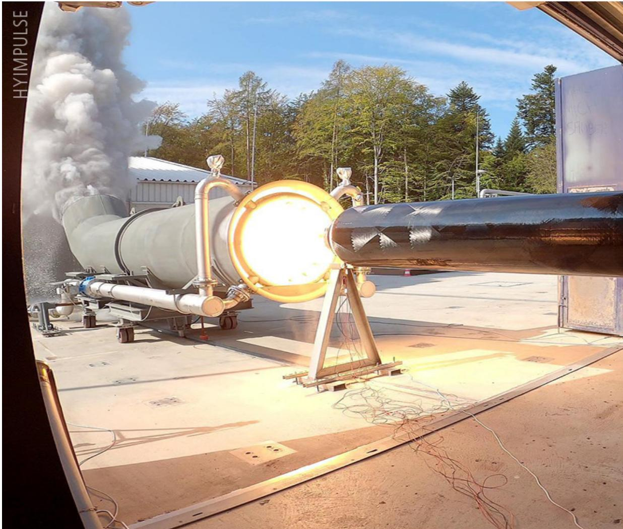
Test Hylmpulse Hybridantrieb in Lampoldshausen
