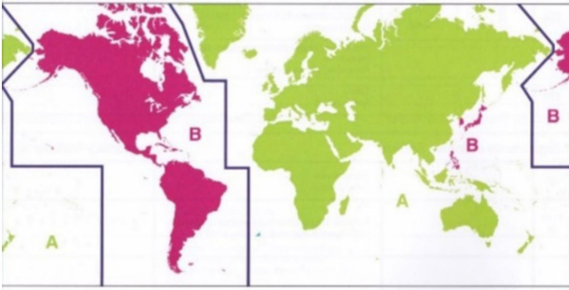
Genau in diesen Ländern, in denen das Betonungssystem B gilt (siehe Bild oben), findet man, von See kommend, die roten Tonnen an Steuerbord und die grünen Tonnen an Backbord. Somit hat der Nautiker, wenn er mit seinem Schiff z.B. den Hafen von New York anläuft, die grünen Tonnen auf der Backbord- also der linken Fahrwasserseite.
