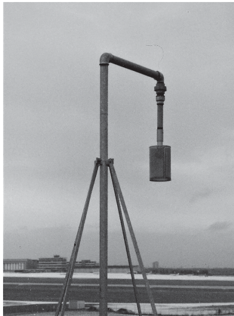
Abb. 2. Mikrophongalgen mit Windschutz auf Flachdach
