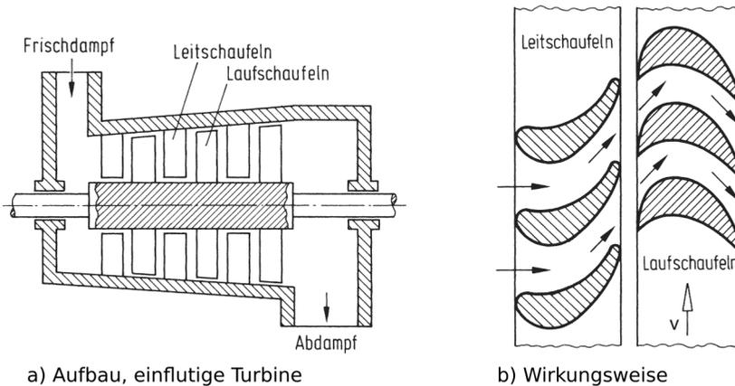
**Bild 2.8** Prinzipieller Aufbau und Wirkungsweise der Dampfturbine
