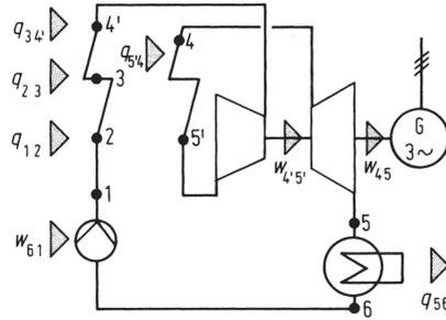
**Bild 2.4** Dampfkraftwerksprozess mit Zwischenüberhitzung
