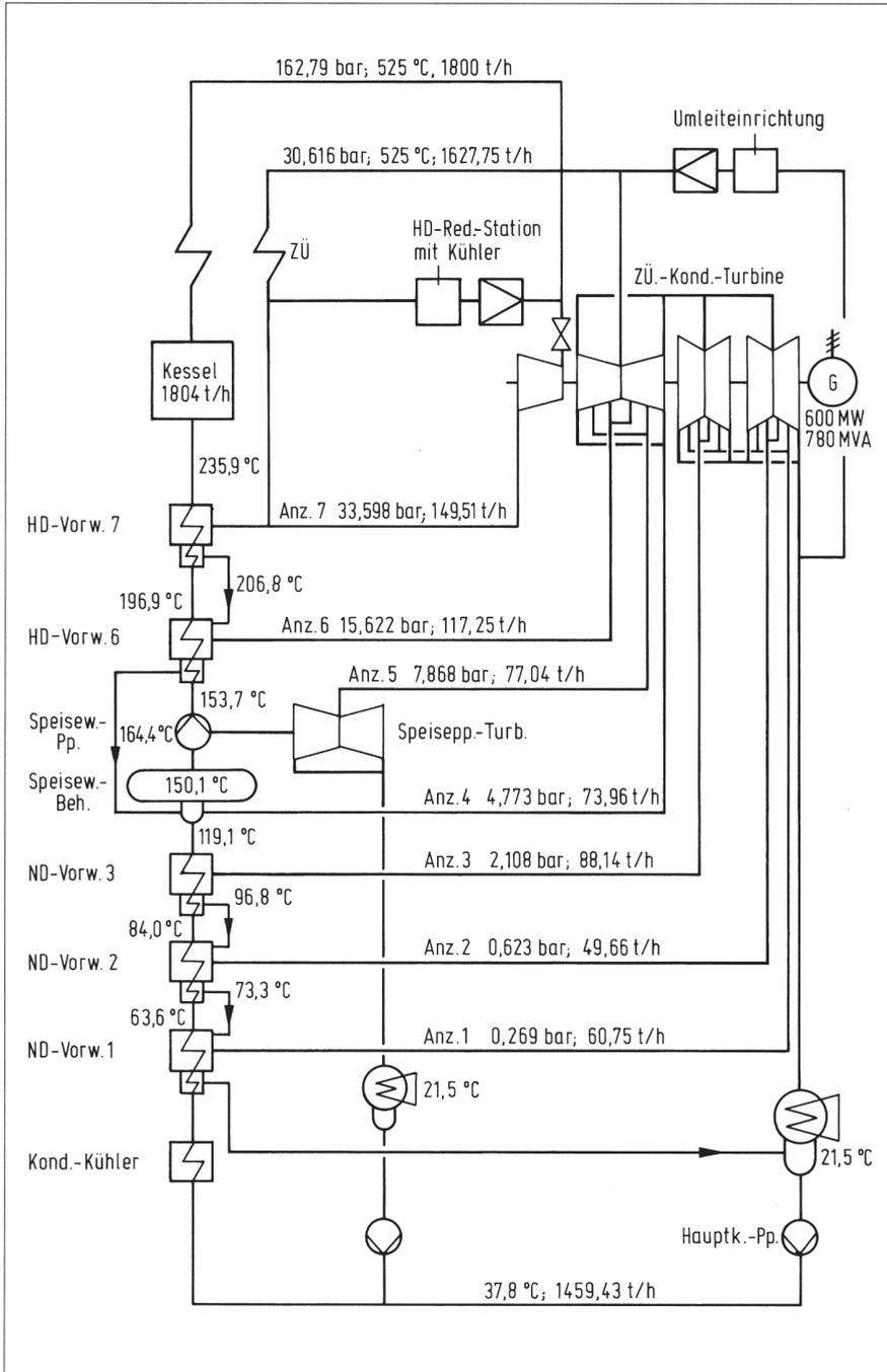
**Bild 2.5** Wärmeschaltbild 600 MW-Block des Braunkohle-Kraftwerkes Neurath
