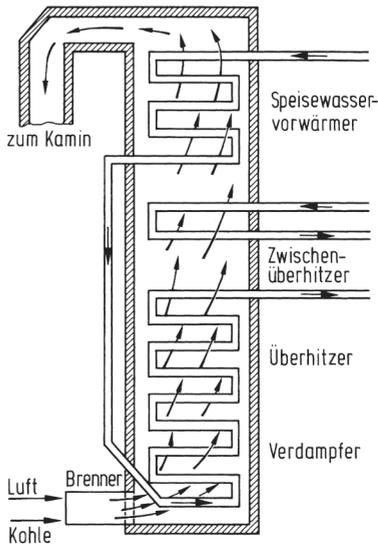
**Bild 2.7****Prinzip eines Dampferzeugers**
