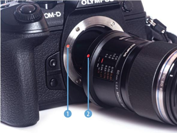
◀ Die beiden roten Punkte am Kamerabajonettring ① und am Kameraanschluss ② des Objektivs müssen übereinstimmen.
