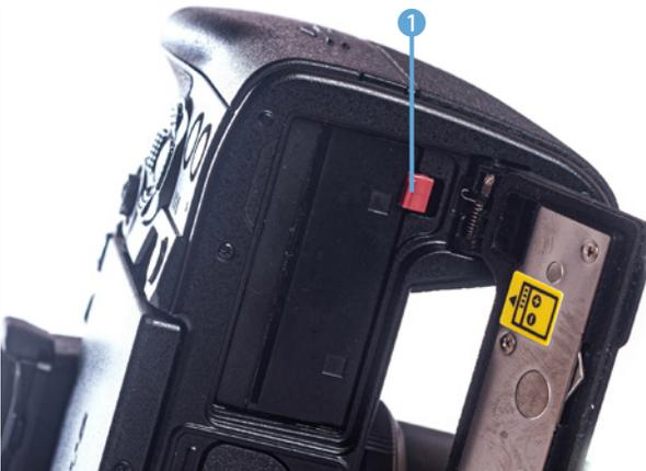
◀ Haben Sie den Energiespeicher korrekt eingelegt, schiebt sich beim Einrasten die rote Lasche ① über den Akku, sodass dieser fixiert wird. Diese schieben Sie an die Seite, um den Akku zu entnehmen.
