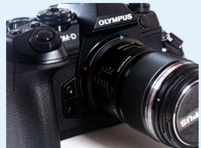
▲ Haben Sie das Objektiv gerade angesetzt, drehen Sie es mit leichtem Druck im Uhrzeigersinn, bis es einrastet.
