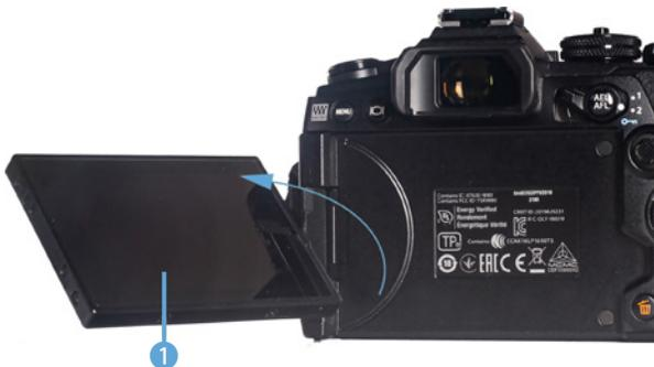
◀ Im zweiten Schritt drehen Sie das Display **1** gegen den Uhrzeigersinn um 180° um die eigene Achse.
