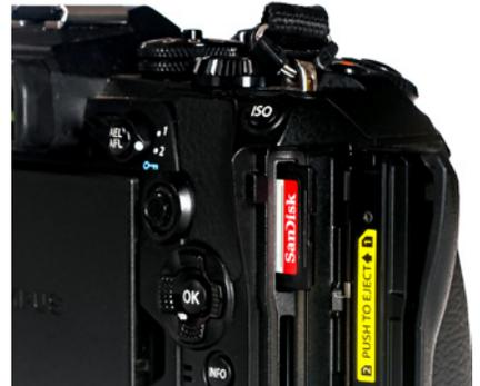
▲ Schieben Sie die Speicherkarte mit der abgeschrägten Ecke nach oben und den Kontakten in Richtung Objektiv in den Speicherschacht.
