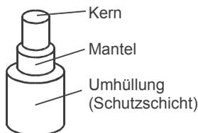
Die Schutzschicht ist eine zweischichtig aufgebaute Kunststoffhülle, die die Festigkeit des Lichtwellenleiters verbessert, nach innen Mikrokrümmungen verhindert und nach außen eine einfachere Handhabung ermöglicht.
