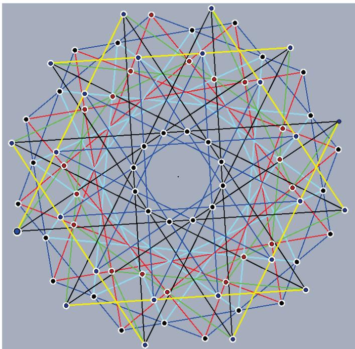
**Abbildung 1.8** Eine Punkt-Geraden-Konfiguration mit 78 Punkten und 78 Geraden. Durch jeden Punkt gehen vier Geraden, und auf jeder Geraden liegen vier Punkte. Der größer dargestellte blaue Punkt links kann mit der Maus in der zugehörigen Cinderella Datei bewegt werden. Dabei bleibt die Konfigurationseigenschaft erhalten
