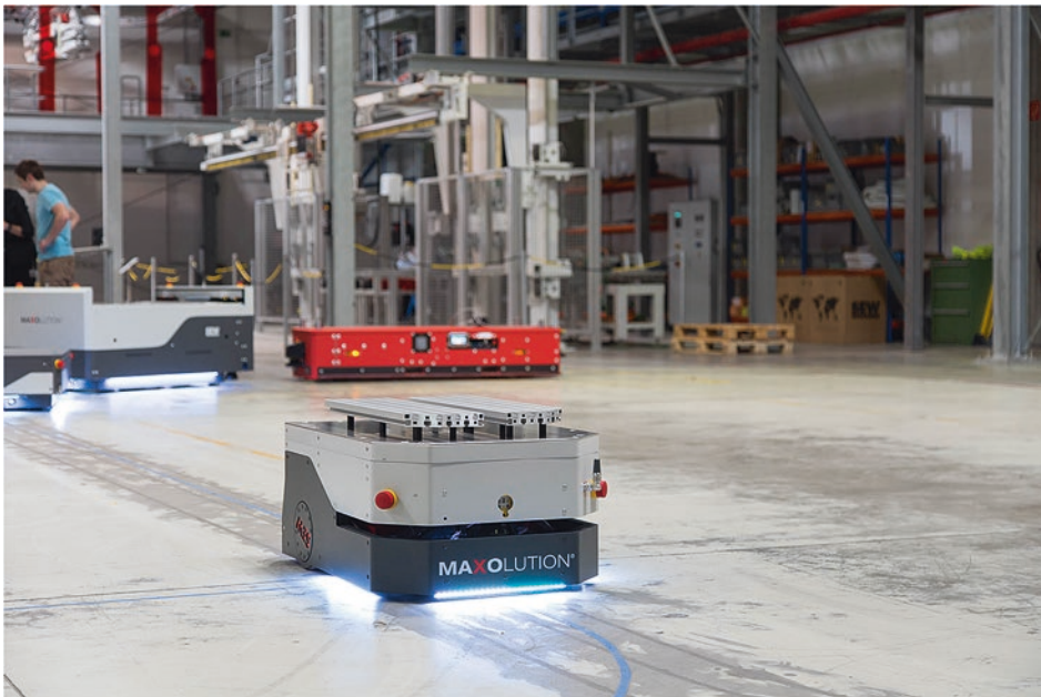
Abb. 1.3 Fahrerloses Transportsystem (FTS). (Quelle SEW Eurodrive)
