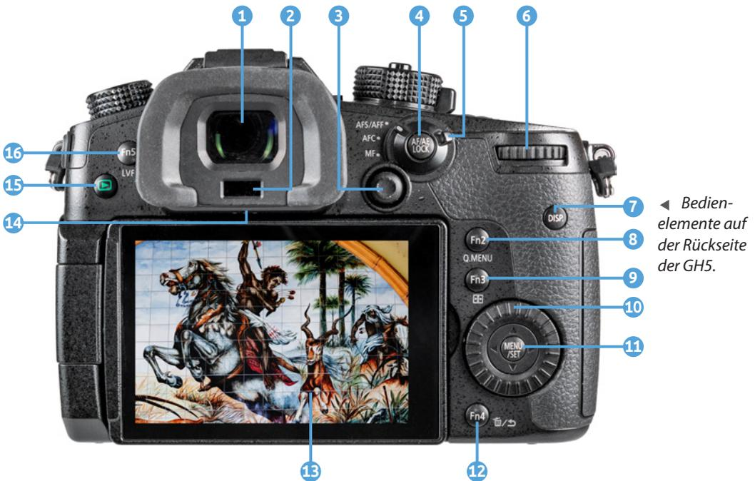
Die Rückseite der GH5 hält die meisten Bedienelemente bereit. An annähernd der höchsten Stelle der Kamerarückseite befindet sich der **elektronische Sucher** ①, mit dem sich Bildaufbau, Belichtung und Bildergebnis auch bei sehr viel Umgebungslicht bestens begutachten lassen. Unterhalb des Suchers liegt der **Augensensor** ②, der bei Annäherung für ein Umschalten des Bildes vom Monitor auf den Sucher sorgt.
