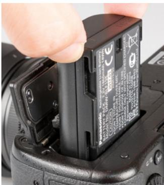
▲ Einlegen des Akkus in das Akku-Fach auf der Unterseite der GH5.
