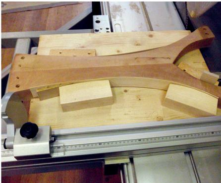
**17** | Ein einfaches Brett, mit Halteklötzen versehen, lässt Sie die Beinteile jeweils exakt gleich ablängen: Wichtig für den kippelfreien Stand des Tisches.
