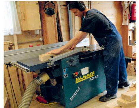
**7** | Die 65 Millimeter Dicke lassen nun viel Spielraum für das Abrichten der ausgesägten Beinhälften.
