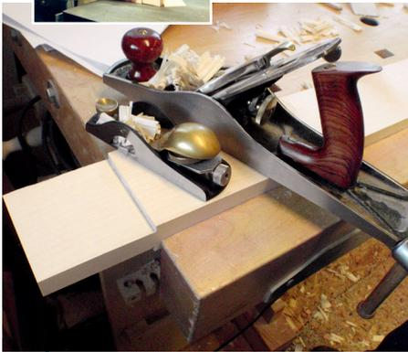
**21** | Mit der Bandsäge angeschnittene Zapfen lassen sich mit Handhobeln ausgezeichnet passend fürs Zapfenloch zurichten. Besonders flachwinklige Blockhobel (links im Bild) zeichnen sich hier aus.
