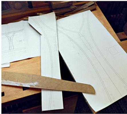
**1** Die Schablonen (abgenommen aus den größer kopierten Zeichnungen) werden wellenfrei auf die Trägerplatten aufgeklebt. An den Schnittbereichen muss das Papier dicht haften, damit sich keine Fehler einschleichen.
