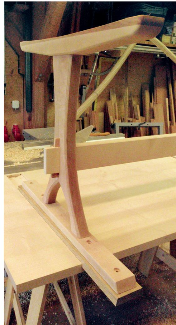
**25** | Das fertig verbundene Gestell wird später unter die Eiche-Gratleisten geschraubt (hier ein Testlauf). So ergibt sich eine handwerklich perfekte Verbindung von Platte und Untergestell.
