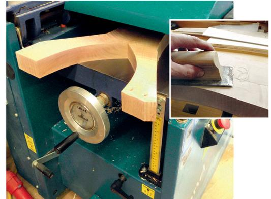
**13** | Sofern Sie Zugang zu einem breiten Dickenhobel haben, kann das Teil auch darin ausgehobelt werden. Alternative: Alles vorher auf Dicke bringen. Nach dem Verleimen mit Dübeln sollte kein Versatz bleiben. Der ausgetretene Leim wird entfernt.
