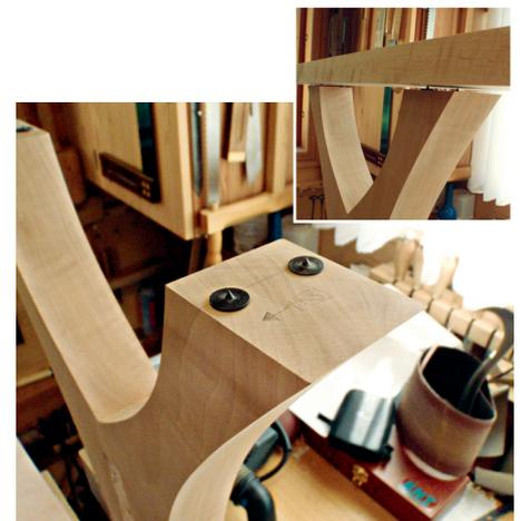
**20** | Mittels Dübelspitzen lassen sich Bohrpunkte genauestens auf die Schwelle und Riegel (hier im Bild) übertragen.
