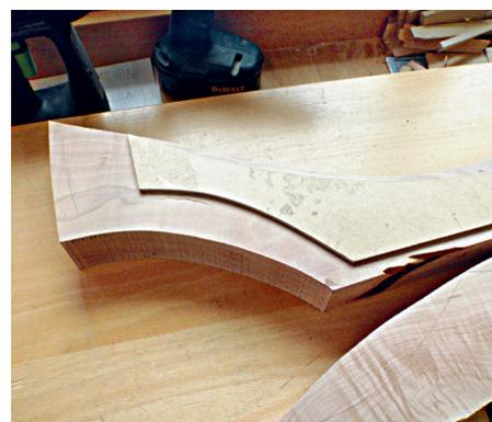
**8** Jetzt wird die Schablone endgültig mit den Fasern in Deckung gebracht und die Leimfuge (die gerade Kante) festgelegt.
