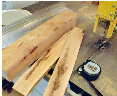
**6** | Auf der Bandsäge führt der Schnitt jetzt nah an den Riss heran. Dabei offenbart sich ein typischer versteckter Mangel von Birnbaum: eingewachsene Rinde. Gut, dass noch ein weiterer Rohling als Reserve bereitsteht.
