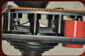
Die hohe Qualität des CX-10 wird besonders durch die stabilen Federn deutlich, die die Bewegung übertragen. Der Feuerknopf verleiht dem Stick noch mehr Automaten-Feeling.
