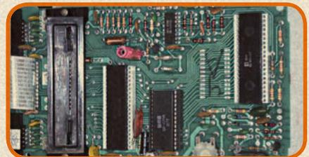
Das Motherboard des 2600 ist ziemlich klein. Abseits der Flachkabel zu den Schaltern und dem Cartridge-Port gibt es nur drei Chips (von links nach rechts): die 6507-CPU, den RIOT von MOS und die Grafikeinheit TIA.
