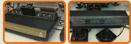
Die ersten 400.000 Einheiten des 2600 hatten ein markantes, dickes Plastikgehäuse mit geschwungenen Kanten. In der Revision von 1978 wurde das Plastik dünner, die Form eckiger. Genauso wie die Launch-Version bietet diese Revision aber sechs Schalter zum Ein- und Ausschalten, Wahl des TV-Typs (Farbe oder schwarz-weiß), Spielauswahl, Reset, Schwierigkeitsgrad für linken und rechten Spieler. Die beiden letzten Schalter wanderten später auf die Rückseite.
