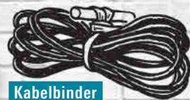
aus Rundholz und Gummiband gefällig? Das Band herumwickeln, die Schlaufen ineinander stecken und festziehen. Dann das Gummiband um die Kabel ziehen und die lose Schlaufe wieder am Rundholz einhaken.
