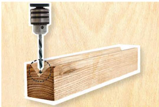
**3. Den V-Block** auf dem Tisch der Ständerbohrmaschine so positionieren, dass der Bohrer sich genau in die Spitze senkt. Ganz genau wird es, wenn Sie es vorher per Mini-Bohrer zentrieren.
