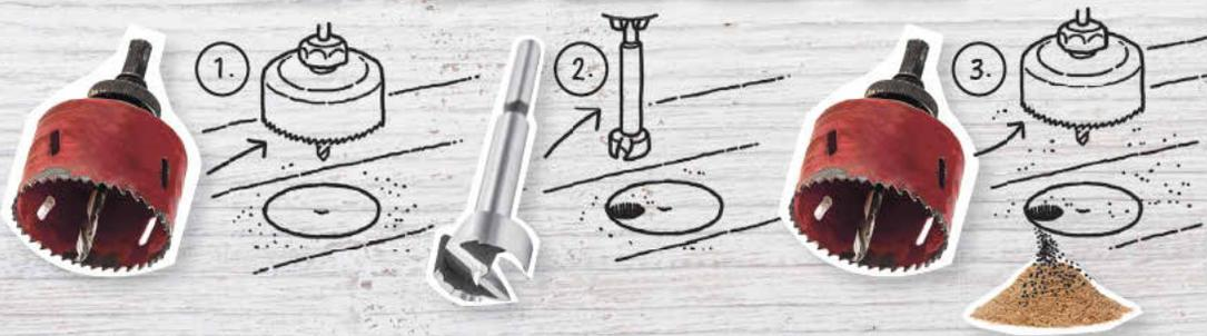
**SO GEHEN SIE VOR**, um beim Sägen nicht dauernd unterbrechen und das angesammelte Sägemehl entfernen zu müssen: Das Loch mit der Lochsäge leicht anbohren, sodass sich der Umfang des Lochs deutlich auf dem Holz
