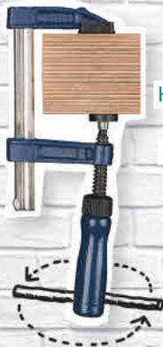
Mittig ein Loch durch den Holzgriff bohren und ein dünnes Rundholz durchstecken. So hat man gleich eine größere Hebelwirkung.
