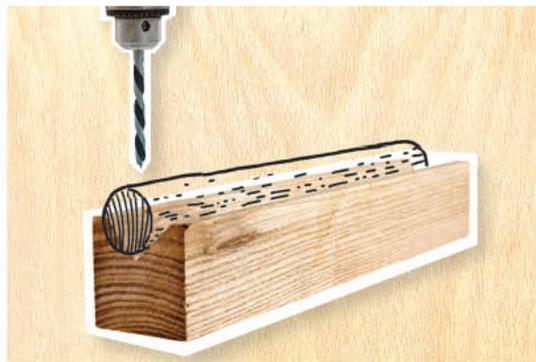
**4. Mit einer Zwinde** den V-Block am Bohrtisch festklemmen. Das Rundholz ins V legen und an der gewünschten Stelle das Loch mittig hineinbohren.
