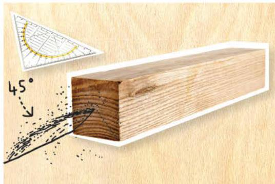
**2. Den Winkel der Tischkreissäge** auf  $45^\circ$  stellen und in die Mitte des Kantholzes mit zwei Schnitten eine V-Form schneiden.
