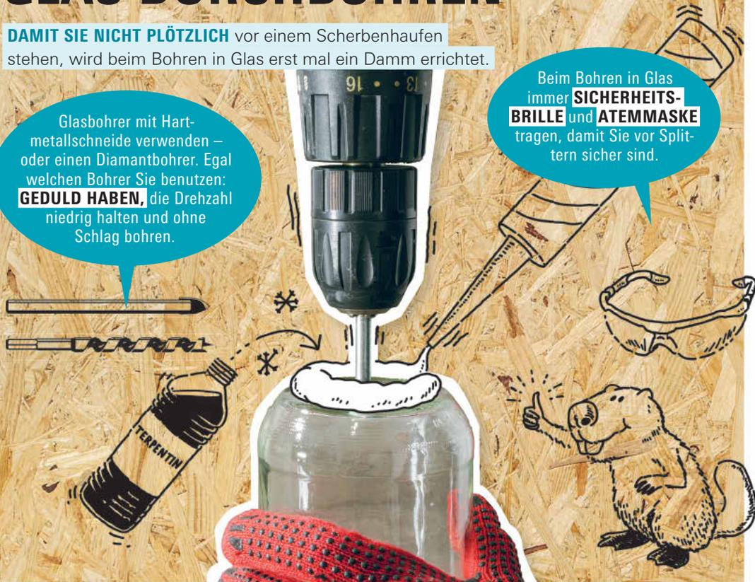
**HABEN SIE BISHER NUR HOLZ** durchlöchert, auf jeden Fall vorher an einem entbehrlichen Stück Glas üben. Die Glasplatte oder Fliese auf einen flachen Untergrund legen, z. B. eine Holz- oder Styroporplatte. Rundherum um die Bohrstelle
