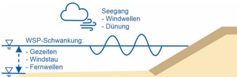
**Abb. 1.2** Schwankende Wasserstände und Seegang vor/am Seedeich
