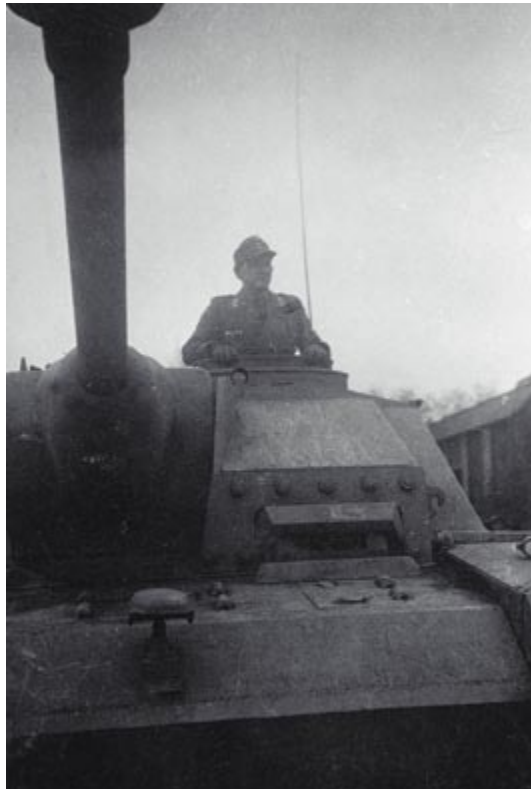
Bild 1: Schwerlast „Sturmgeschütze“ mit einem Bruttogewicht von ca. 30 t pro Geschütz eine Nagelprobe für jede Brückenkonstruktion
