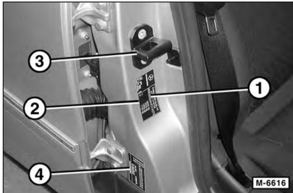
Die Fahrgestell-Nummer (Fg-Nr.) oder Fahrzeug-Identifizierungsnummer (FIN) –1– befindet sich auf dem Typschild –2– unterhalb des Türschließzapfens –3– der Beifahrertür. 4 – Lacknummer.
