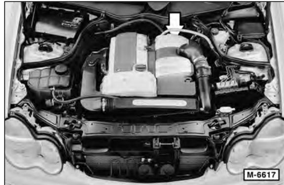
Die Motornummer ist in den Motorblock eingeschlagen.
