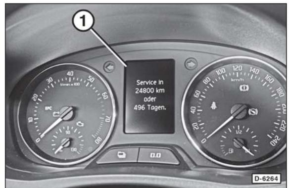
Der Zeitpunkt für die Wartung wird dem Fahrer über die »**Flexible Service-Intervall-Anzeige**« nach dem Einschalten der Zündung im Display –1– des Kombiinstrumentes angezeigt. Hier: nächste Wartung in 496 Tagen oder 24.800 km. **Hinweis:** Je nach Ausführung erscheint zusätzlich ein Schraubenschlüsselsymbol im Display.
