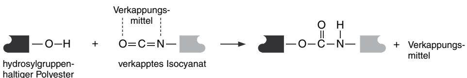
Abb. 1.10 Polyurethan Beschichtungspulver. Umsetzung eines hydroxylgruppenhaltigen Polyesters mit einem verkappten Isocyanat [26]
