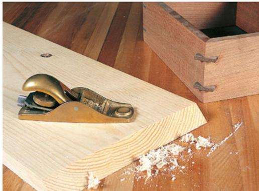
Die Brüstungen eines Zapfens werden mit dem Simshobel verputzt.
