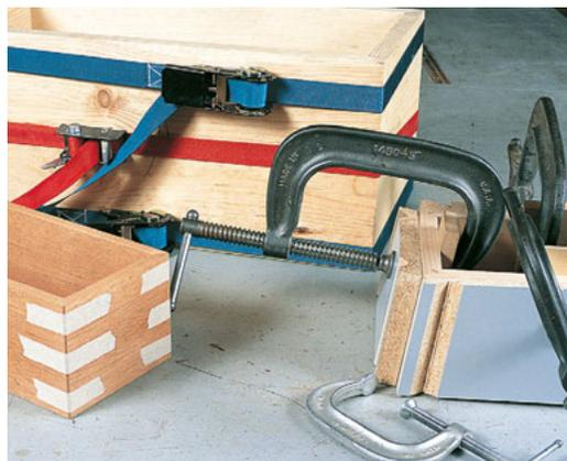
Gehrungsverbindungen werden zum Verleimen mit Bandspannern oder Zwingen und Zulagen eingespannt. Kleine, gut auf Passung gearbeitete Gehrungsverbindungen lassen sich auch mit Hilfe von Klebeband verleimen.
