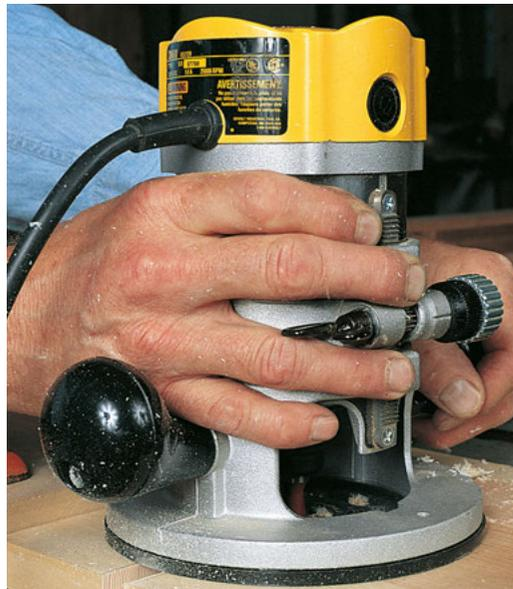
Die Schnitttiefe wird bei Handoberfräsen, die nicht eintauchen können, durch Verstellen des Motors im Fräskorb eingestellt.
