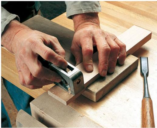
Stoßladen unterschiedlicher Form halten Werkstücke beim Hobeln, Sägen und Schärfen.
