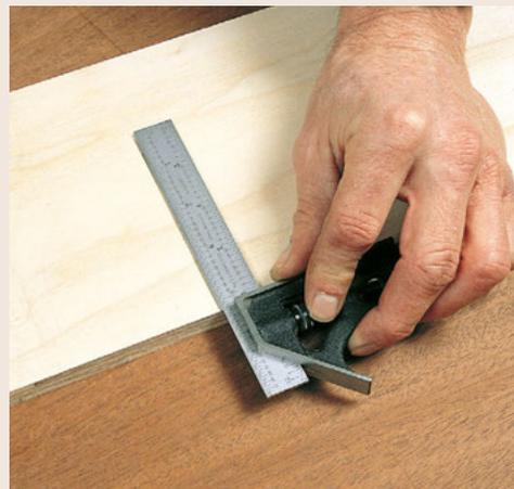
Die Rechtwinkligkeit eines Tischler- oder Kombiwinkels wird überprüft, indem man senkrecht zu einer Kante eine Linie damit anreißt. Dann wird der Winkel umgedreht, und die Übereinstimmung mit der gezeichneten Linie kontrolliert.
