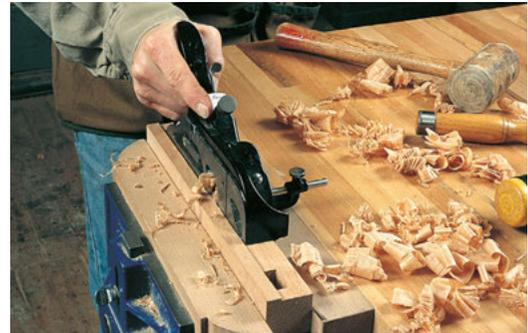
Ein Falzhobel wird während des Schnittes durch einen angebauten Anschlag geführt.
