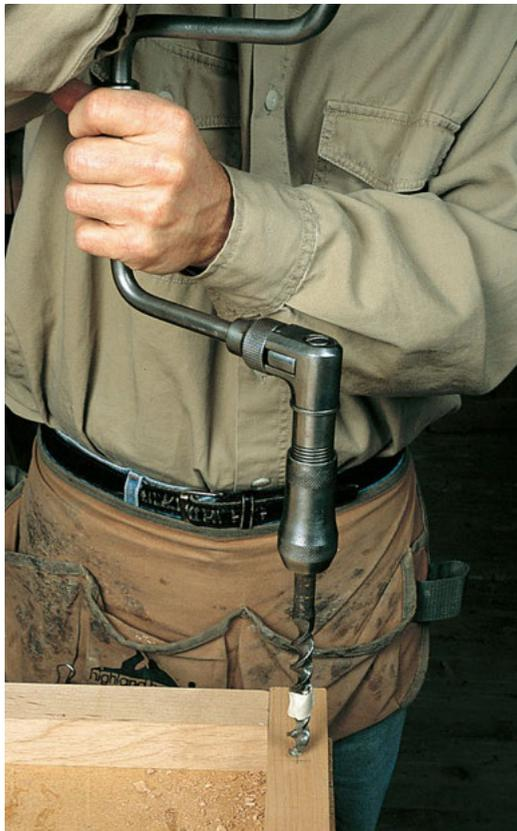
Bei den meisten Handbohrarbeiten wird eine Bohrwinde verwendet.
