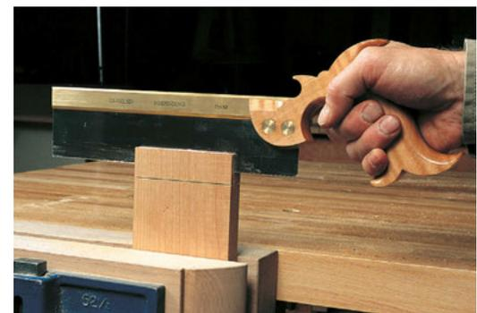
Bei einer Schlitzsäge sind die Zähne für Auftrennschnitte zugefeilt. Sie ist besonders zum Schneiden von Zapfen und Schwalbenschwänzen geeignet; auf Englisch heißt sie deswegen sogar „dovetail saw“.
