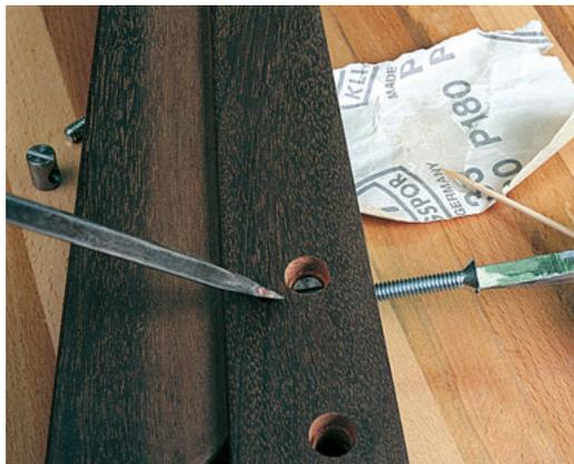
Das Bit für eine Schraube mit Innenvierkantkopf sollte genau passen, damit man sicher schrauben kann.
