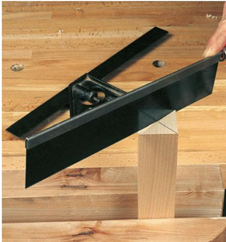
Setzen Sie den Schnitt an einer Ecke des Werkstücks an. Bewegen Sie die Sägen in der entgegengesetzten Richtung zu jener, in der sie schneidet.
