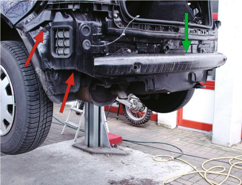
**Abb. 3-2** Heckpartie Golf IV/Stoßfängerabdeckung demontiert
