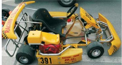
**Bild A-8** Kart: Monoposto, keine beweglichen Teile bei der Radaufhängung, kein Differential.
