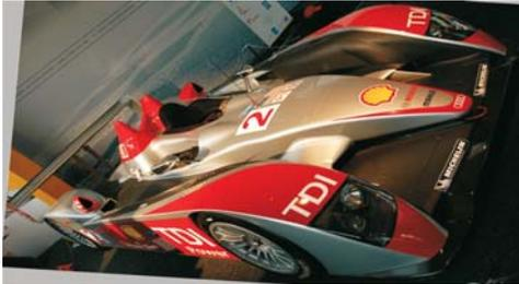
**Bild A-7** LMP1-Fahrzeug: Langstreckenfahrzeug mit offenem, zweisitzigen Cockpit und umschlossenen Rädern.
