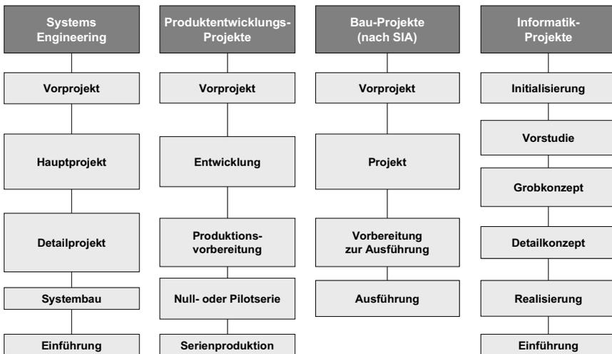
Abbildung I-7: Phasenmodelle und Phasenbezeichnungen
